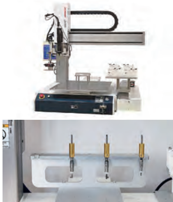
写真上:タンダレス・インサート自動挿入機 写真下:ツールチェンジャー
